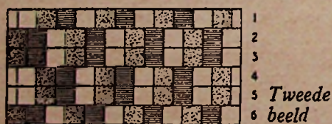
Afb. 1. Vereenvoudigde voorstelling van de kleurverdeling in de aftastlijnen van twee opeenvolgende volledige beelden. Van elk daarvan zijndoor de toepassing der lijnverspringing eerst de oneven lijnen afgetast, daarna de even lijnen.
